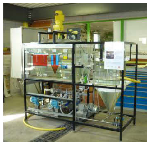
Pilote de station d'épuration à boues activées (PFT GH 2 O)
