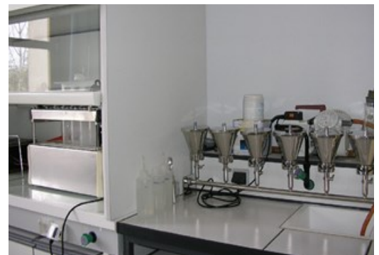
Rampe de filtration-Minéralisateur (Laboratoire des eaux—PFT GH 2 O)
