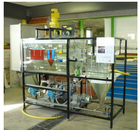
Pilote de station d'épuration à boues activées (PFT GH 2 O)
